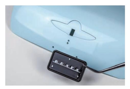
В задней нижней части крышки багажника установите задний номерной знак. Для крепления знака используйте три винта 1,7×4 (АМ). Не закручивайте винты до упора. Плоскость крышки багажника изогнута, и номерной знак не будет плотно прилегать к ее поверхности. Достаточно лишь равномерно подтянуть все три винта для фиксации номерного знака.
